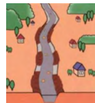
出水により護岸が被災
