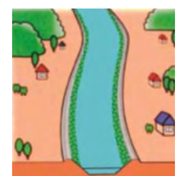
一連区間の護岸嵩上げの実施による改良復旧
