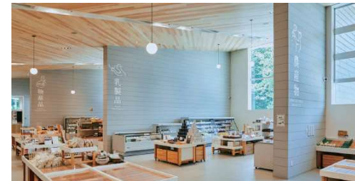
マーケット 勾配天井には屋外から連続する地場の杉板が貼られている。外壁より連続する壁が各エリアをゆるやかに分けている。
