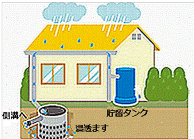
宅地内貯留・浸透施設設置等の推進
