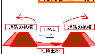
堤防強化・漏水対策
