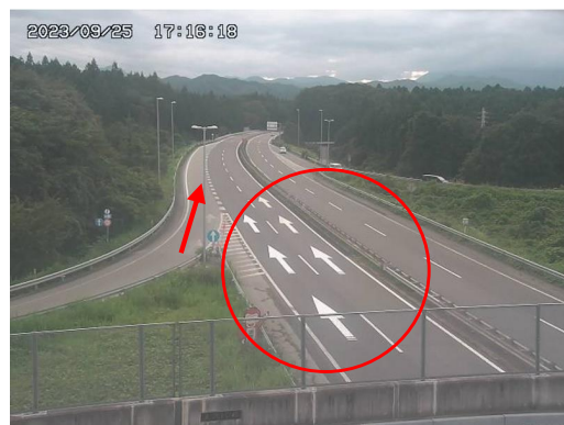
逆走防止対策の例①(路面表示)
