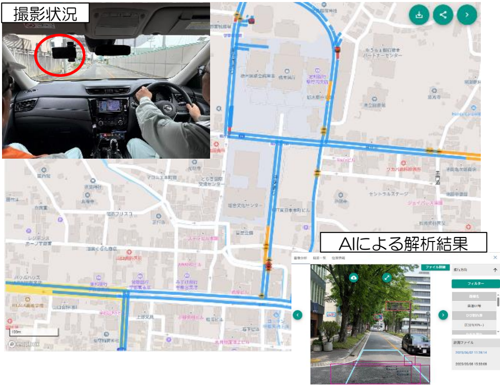
画像診断による舗装点検
