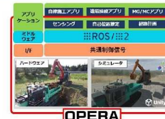
自動施工技術基盤OPERA構成要素
