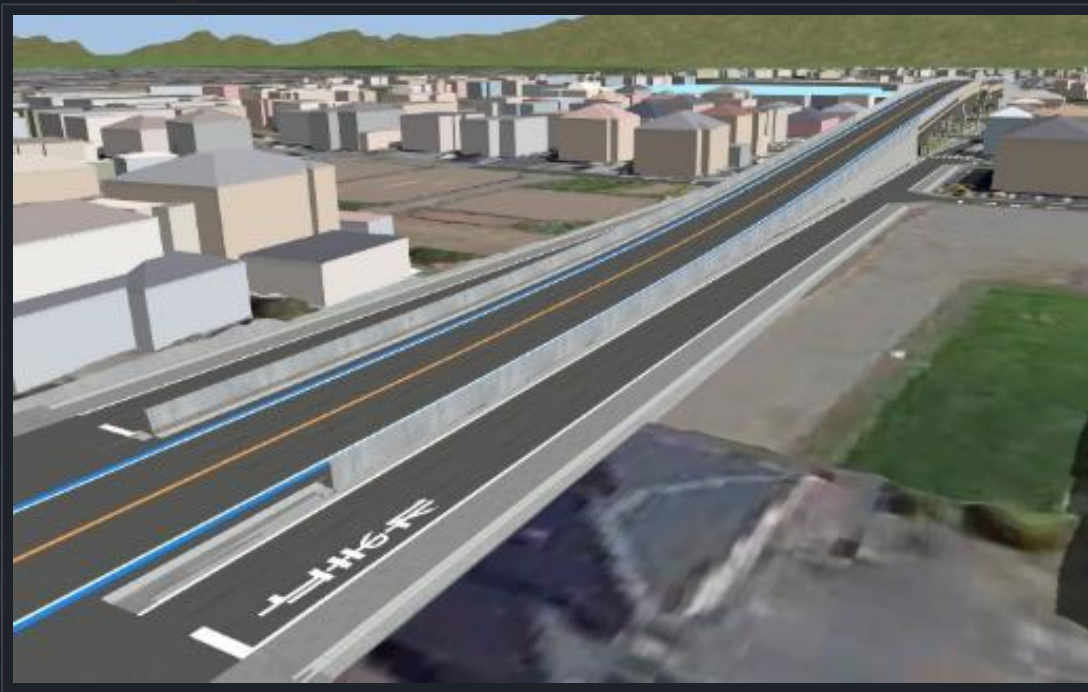
橋梁側（補強土壁工部）
