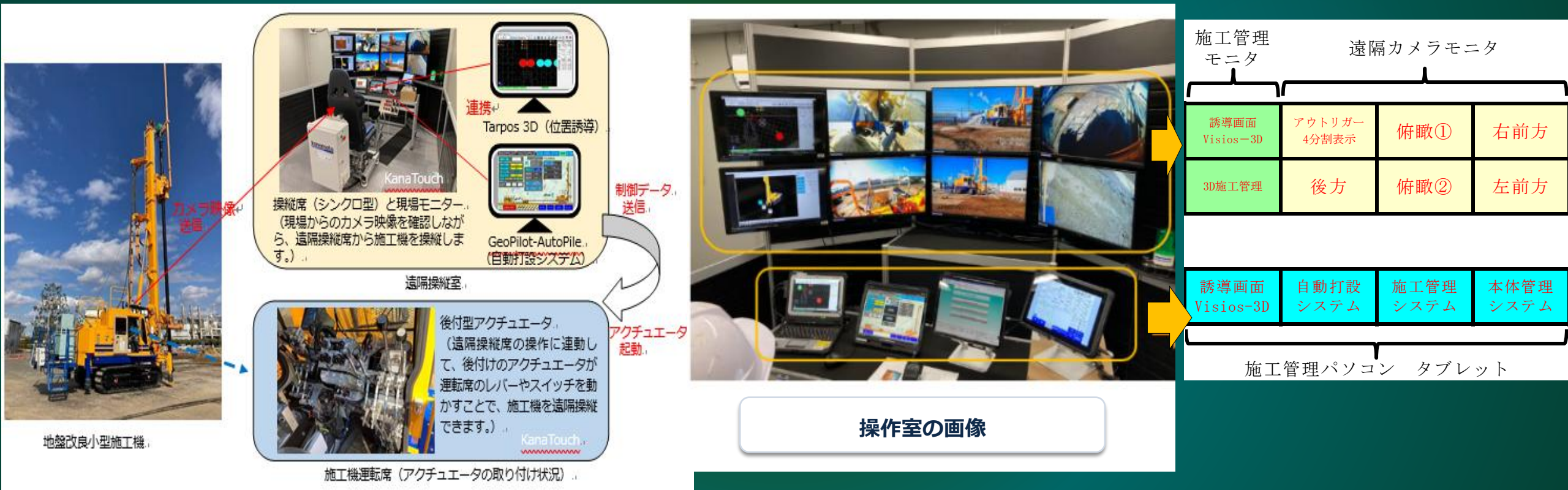
遠隔操縦システム[kanaTouch(カナタッチ)]構成図
