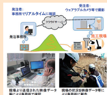
建設現場の遠隔臨場イメージ
