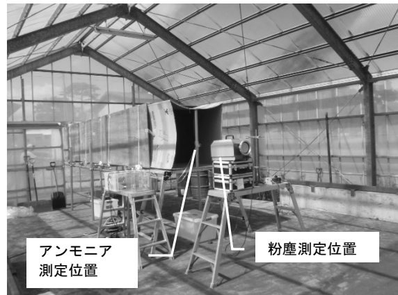
図 3 臭気及び粉塵測定装置
