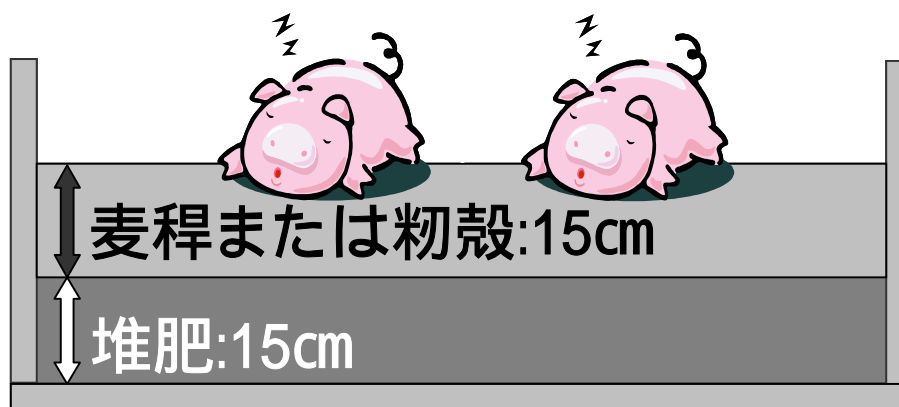
図2 試験「2-2」における床材の模式図
