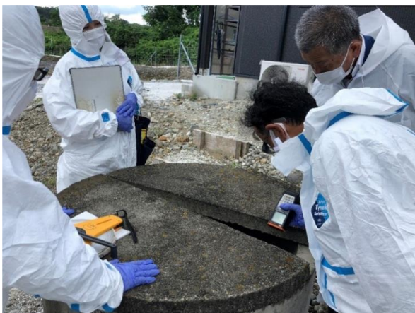
図4 井戸水位の測定
