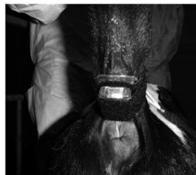
図1 体表温センサと装着時の写真
