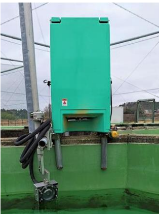
図 1 導入したスマート給餌器
