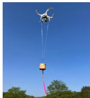
写真2 ドローンでドライアイス投入の様子
