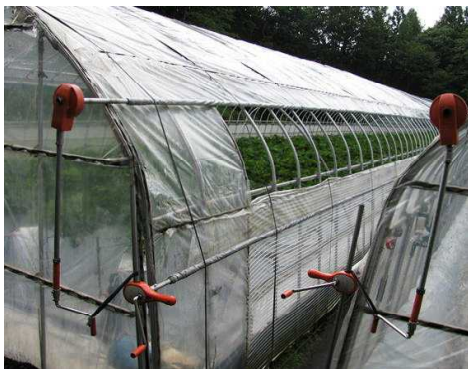
写真10 2段換気の様子
