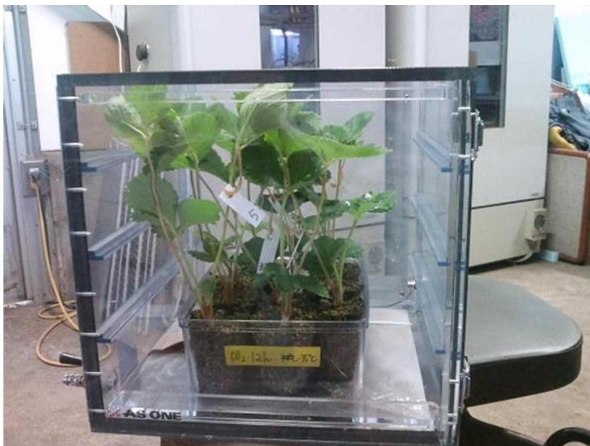
図3-1 ガス置換デシケーターを利用したイチゴ苗処理容器
