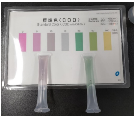
写真 簡易測定キットによる 可給態窒素の簡易測定
