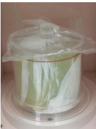
写真5 1L マリネリ容器による測定
