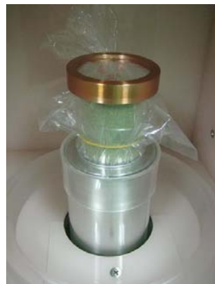
写真6 U8 容器による測定
