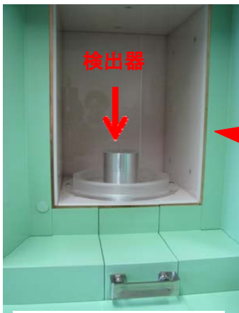
写真1 遮へい体の内部
