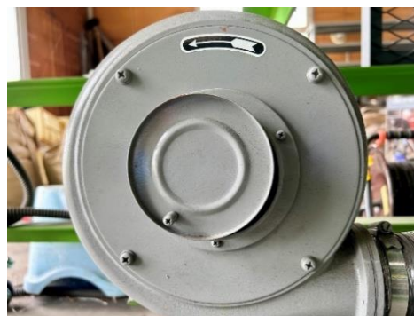
4. ブローアー開口部を5mm ほど開け、10 分おきに1mm ずつ閉める(1mm まで)
