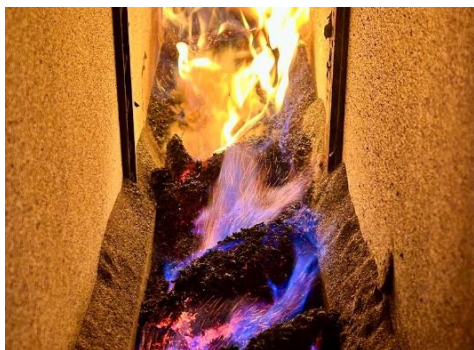
5. タンクのもみ殻を切らさないように補充し続け、連続的に炭化させる
