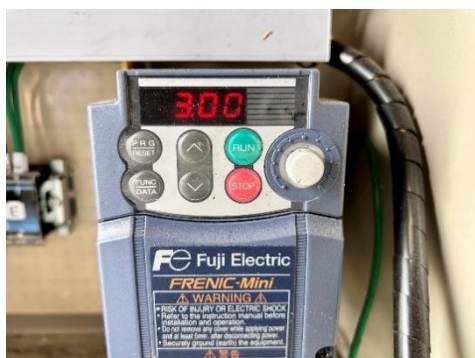
3. 3Hz の速さで流し始め、10 分おきに1Hz ずつ上げていく(10Hz まで)
