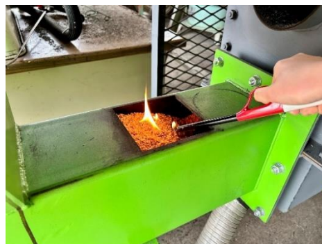
2. 点検口までもみ殻を流し、灯油を200ml ほどかけ、着火する
