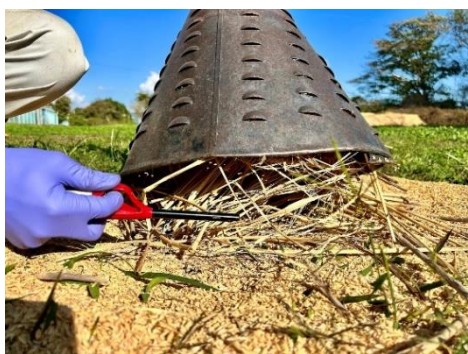
1. 煙突の中に藁を詰め、着火する
