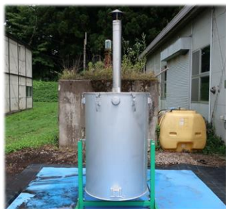
小型機（もみ殻用） （処理能力500L/日、煙が多い）
