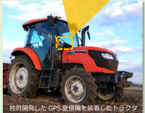
独自開発した GPS 受信機を装着したトラクタ
