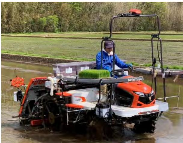
直進アシスト田植機を操作する八木さん。スマート農機の積極的な導入により「質の高い作業の均一化」を目指す。
