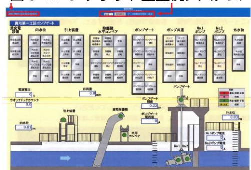
図 5-11-8 クラウド型監視システム
