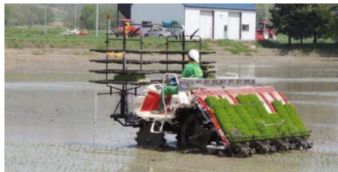
図 5-1-4 苗箱を 48 箱搭載し、一度の苗積みで 520m の作業が可能な田植機
