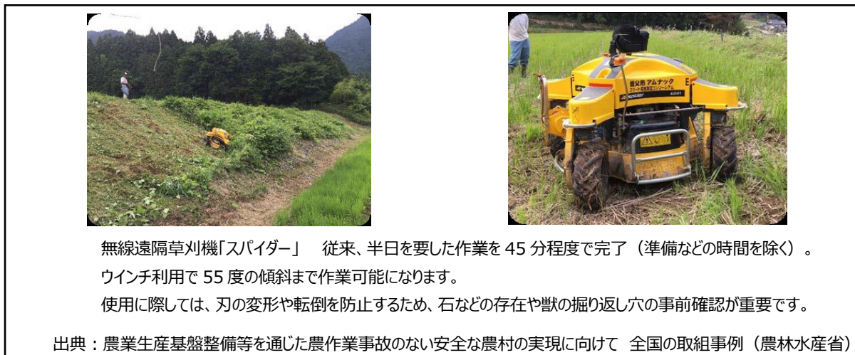
図 5-10-4 無線遠隔操作草刈機による作業時間短縮の事例
