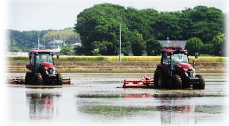
図 4-3 ロボットトラクター2台協調作業
