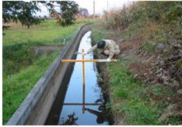
写真2 1次診断 水路の巡回点検
