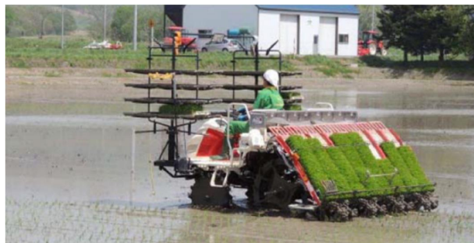
図 5-1-4 苗箱を 48 箱搭載し、一度の苗積みで 520m の作業が可能な田植機
