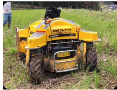
図 5-10-4 無線遠隔操作草刈機による作業時間短縮の事例
