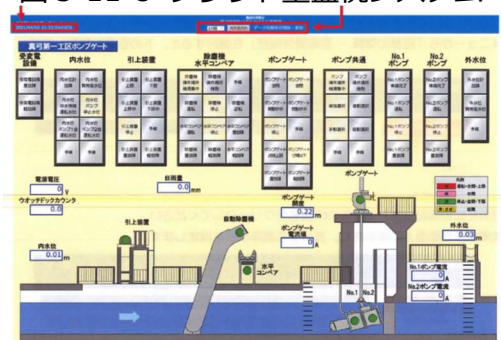
図 5-11-8 クラウド型監視システム
