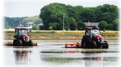
図 4-3 ロボットトラクター2台協調作業
