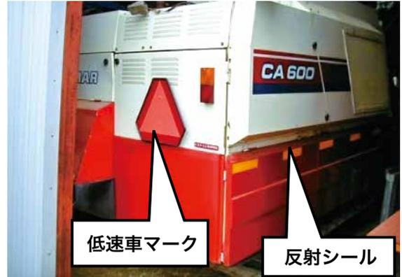
写真3 低速車マークを取り付けたコンバイン
