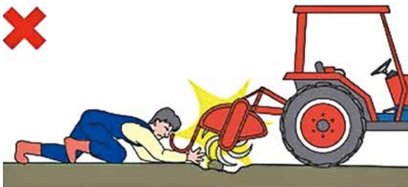
● トラクタ運転作業中に作業機から異音がすると、慌てて機械の中や下をのぞきこみたくなります。作業機の下での作業は、ロータリーに巻き込まれたり、昇降部が落ちたりして、事故につながるおそれがあります。
