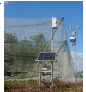
図 なし園に設置された気象モニタリング機器(通信機能付き)
