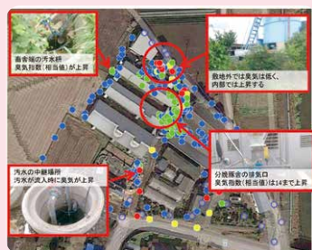
畜産施設における臭気分布と強弱を視覚化する技術 「臭気マップ」
