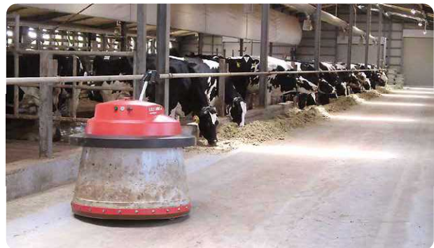
牛舎内の自動エサ寄せロボット
