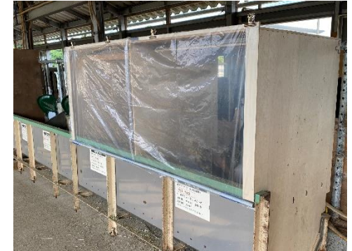
呼気中のメタン測定のための設備
