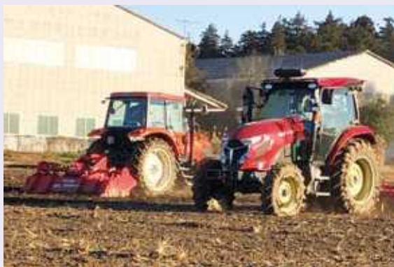
有人トラクター(左)とロボットトラクター(右)による協調作業
