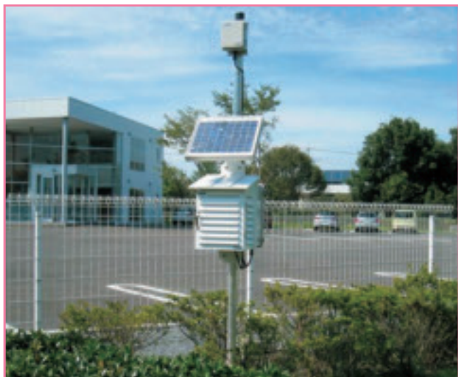
ネットワーク型環境放射線モニタリングシステム G-DAQ(ジーダック)
