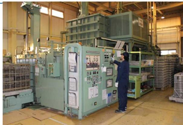
国内最大級真空熱処理炉
