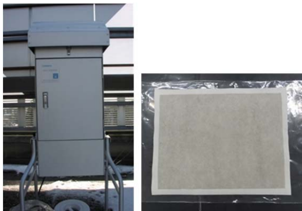
(A) ハイピュラムエアー (B) サンプルング後のろ紙面サンプラー
