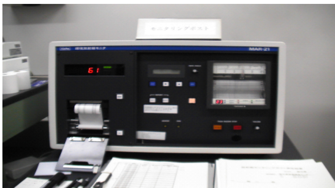
写真 (モニタリングポスト表示部)
