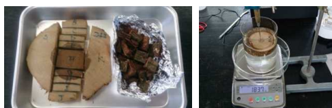
図-2 原木の含水率・密度測定方法
