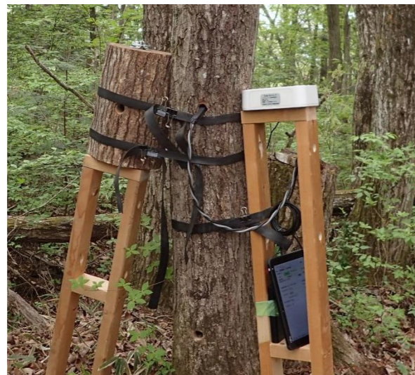
立木用可搬型検査装置 による測定
