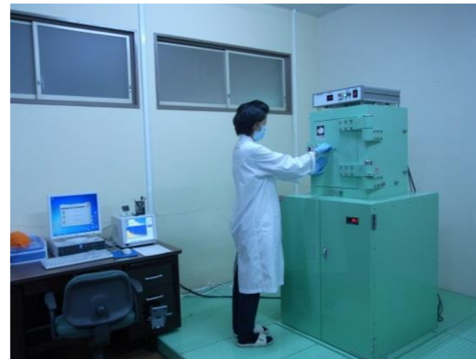
ゲルマニウム半導体 検出器による検査
