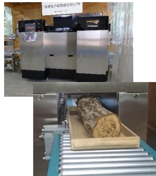
原木非破壊検査装置 による測定
