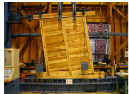
面内せん断性能試験
