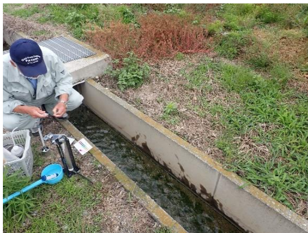
立入検査での工場排水の採取
