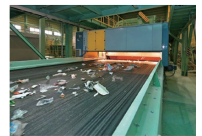
光学センサーによる樹脂素材の選別
