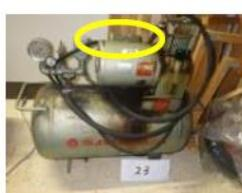
コンプレッサーに取り付けられた低圧コンデンサー
