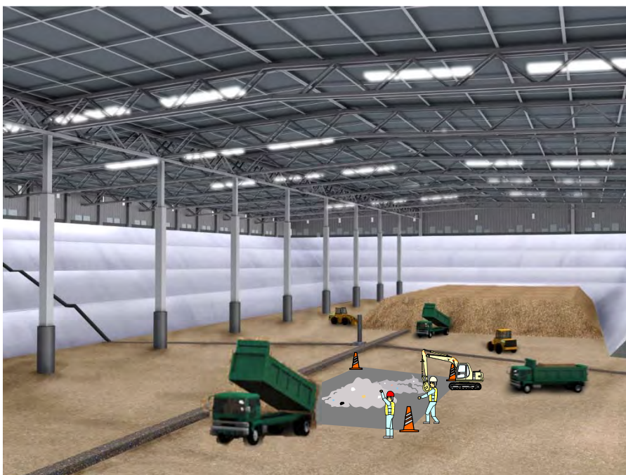
図 4-11-2 埋立地内での展開検査（イメージ図）
