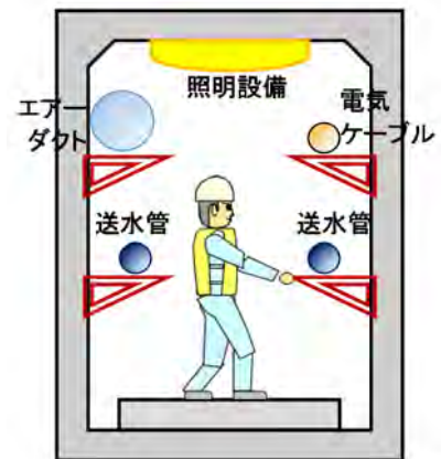
図 4-7-3 点検用通路 概念図（断面図）
