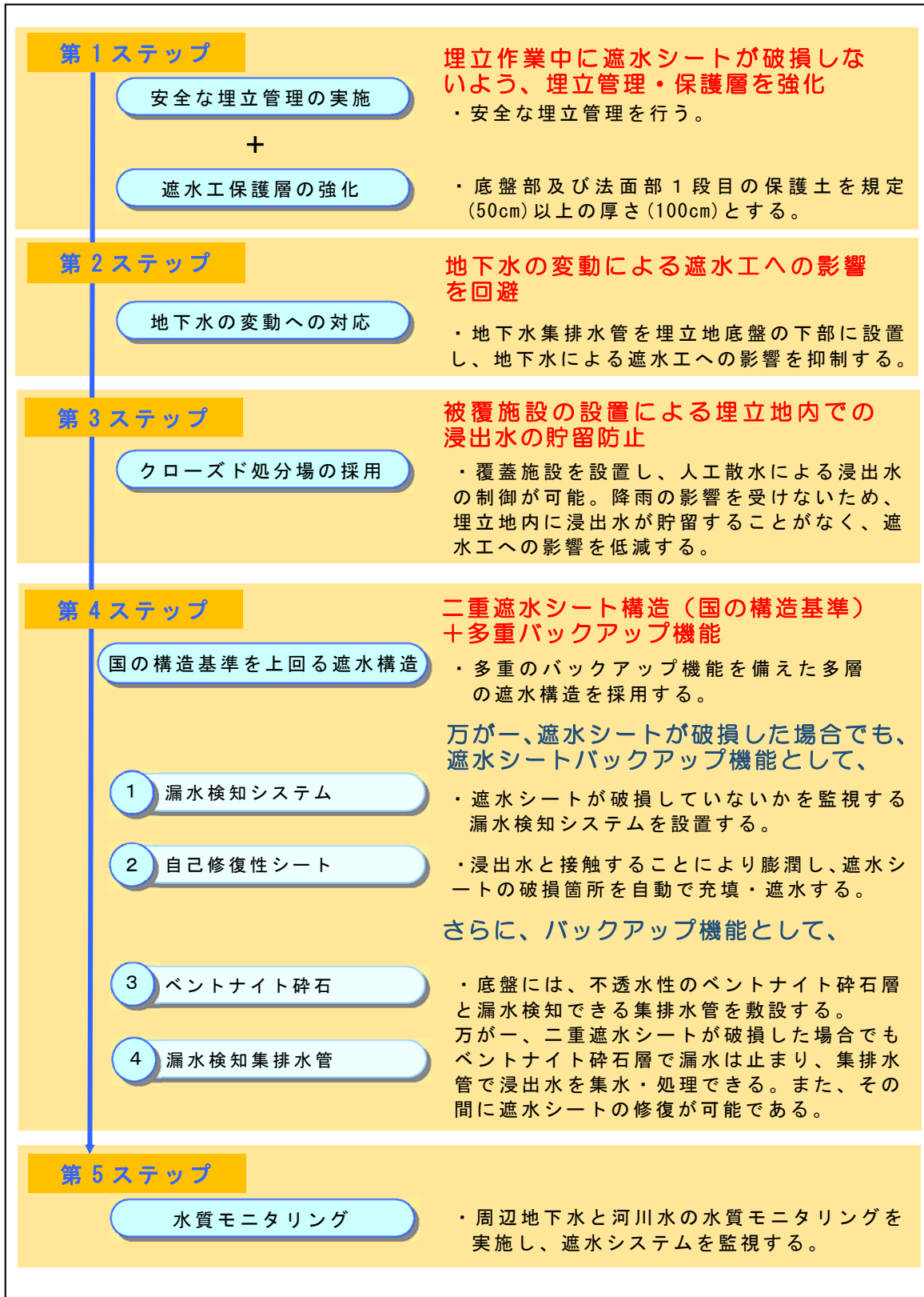
図 4-5-2 遮水における多重安全システムの概要
