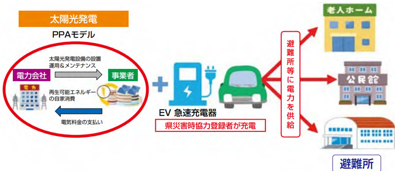
図2-2-4 災害時などに県内各地の地域電源供給拠点からEVで電気を運ぶイメージ
