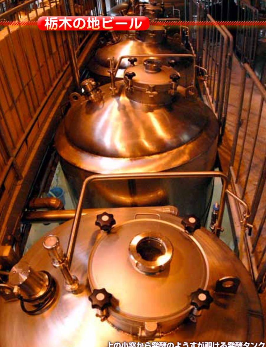
上の小窓から発酵のようすが覗ける発酵タンク
