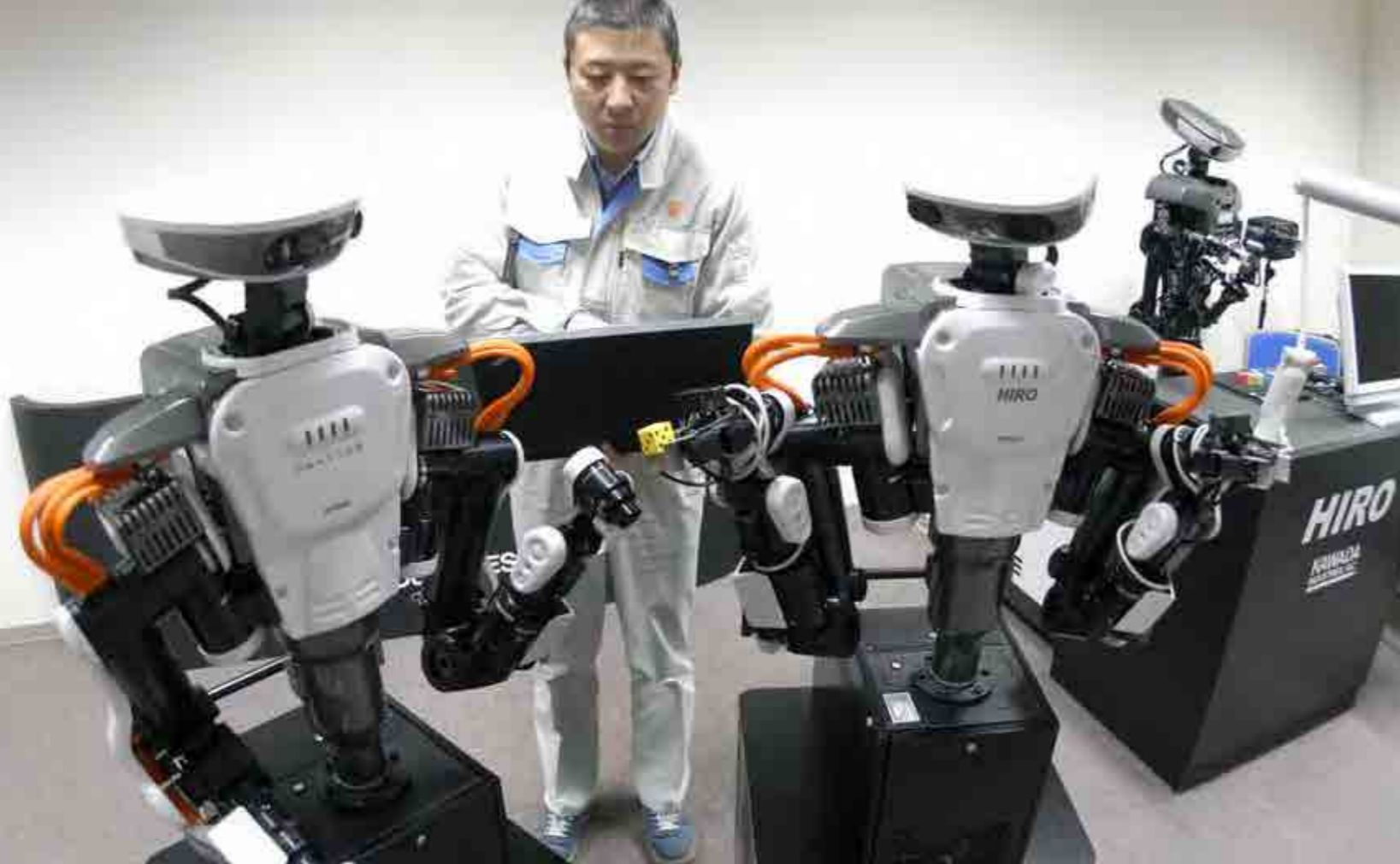
次世代産業用ロボット「NEXTAGE」(左)と研究用上体ヒューマノイドロボット「HIRO」(中央、右奥)
