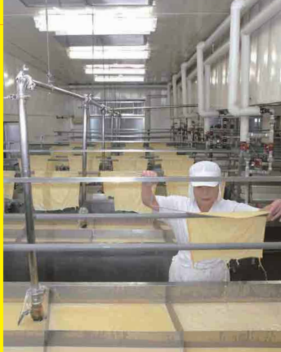
ゆばの「引き上げ」の作業。簡単そうに見えますがきれいにすくいあげるには熟練の技が必要になります
