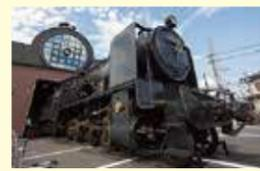
施設名の由来にもなっている「9600型SL(キューロク)」は、大正9年に兵庫県で造られ、現役時代を北海道で過ごした後、真岡市の井頭公園に保存されました。その後、平成25年の「SLキューロク館」オープンに合わせて真岡鐵道に引き取られ、現在では、圧縮空気を動力に、日本で唯一の動く9600型SLとして元気をかせています。
